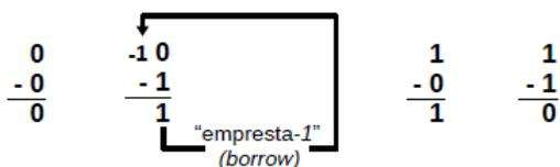
Figura 4. Representação da subtração realizada pelo circuito [2]
